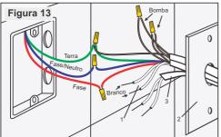
feitas (para garantirem um bom contato elétrico) e isoladas. Então acomode os fios no interior da caixa de luz e fixe o espelho (Fig. 13, nº 2).
