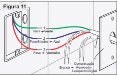
Importante: não use nenhum tipo de plugue ou tomada. Utilize conector e isolação adequados à tensão e corrente elétrica do produto.
