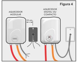
4 - Providencie a instalação elétrica independente para cada Aquecedor com Condutor de Proteção (Fio Terra), fiação em circuito independente para alimentação elétrica do Aquecedor, disjuntor e dispositivo DR no quadro de distribuição de acordo com as indicações a sequir:
